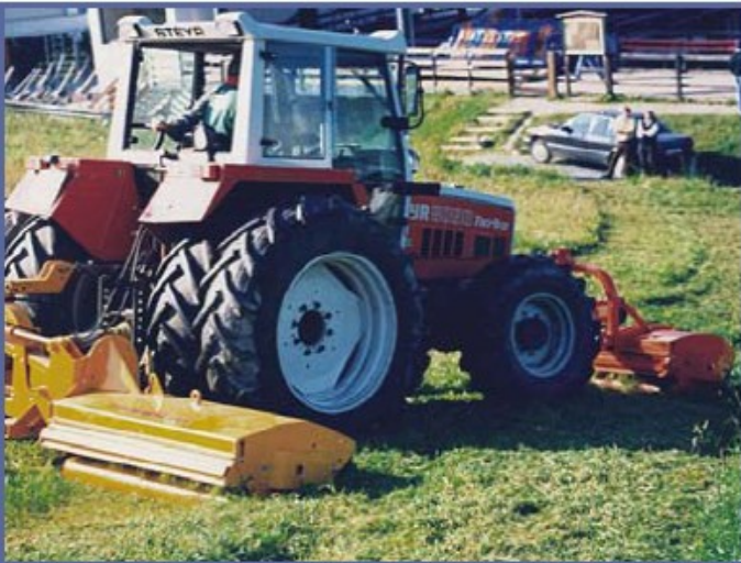
Combinarea unui SMG cu un mulcer montat frontal in vederea obtinerii unei latimi de taiere extinse
