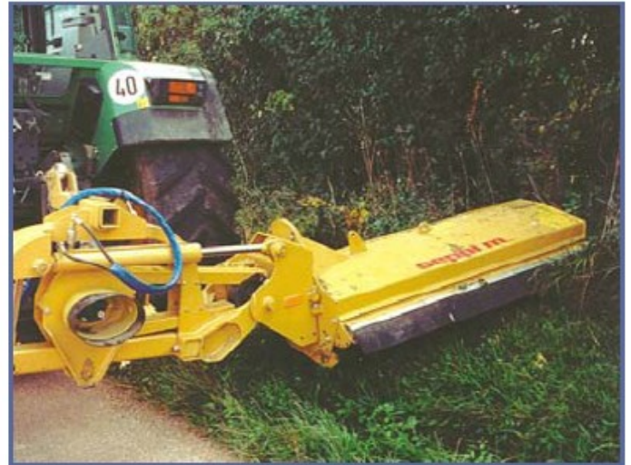
Utilaj reversibil cu sistem de prindere in 3 puncte, ajustabil
