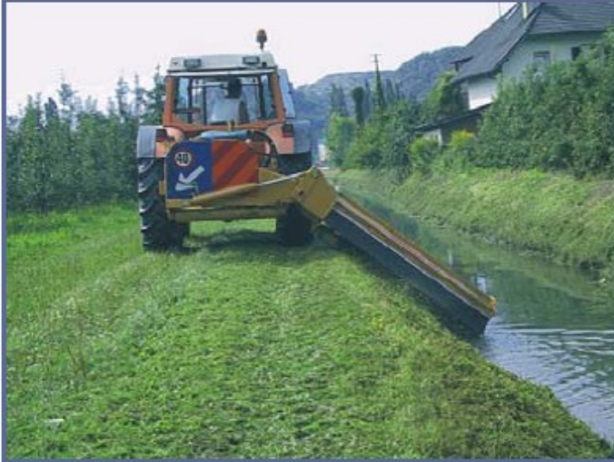
Tambur de susținere atât pentru mulcer cât și pentru sistemul de prindere în trei puncte.
